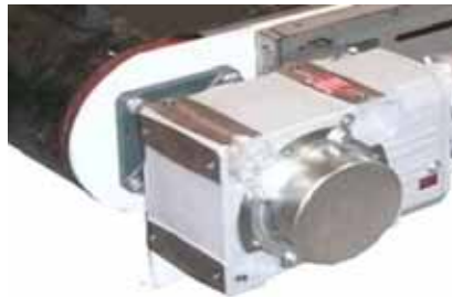
Dettaglio chiusura parti rotanti di cuscinetti e riduttori
