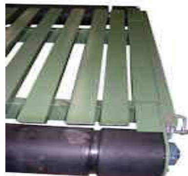
Cilindri gommati provvisti di guida per la tela
